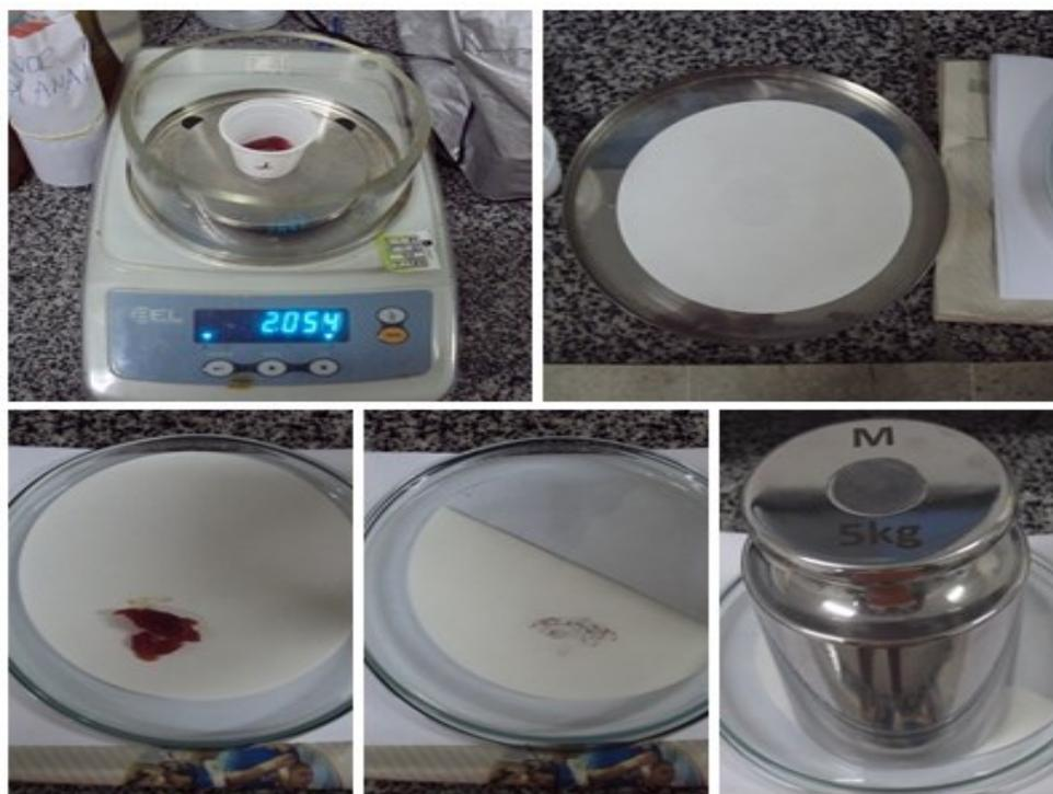
**Figura 1 - Procedimento para obtenção da capacidade de retenção de água**
