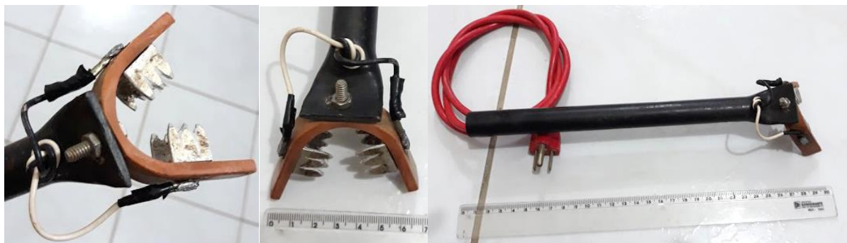
Figura 3. Insensibilizador individual portátil desenvolvido para eletronarcose em codornas.
