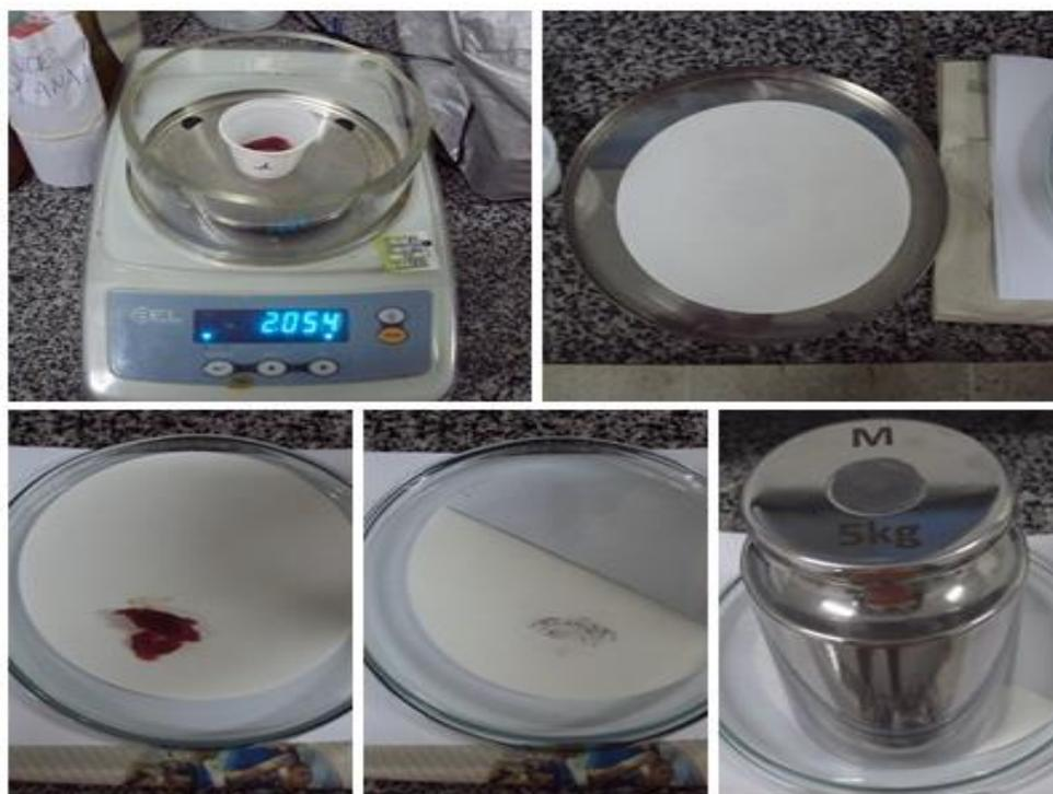
**Figura 5**-Procedimento para obtenção da capacidade de retenção de água.
