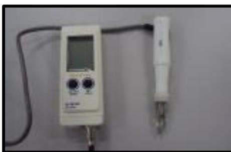
**Figura 4** -Potenciômetro digital acoplado a um eletrodo de penetração. Fonte: Autoria própria.
