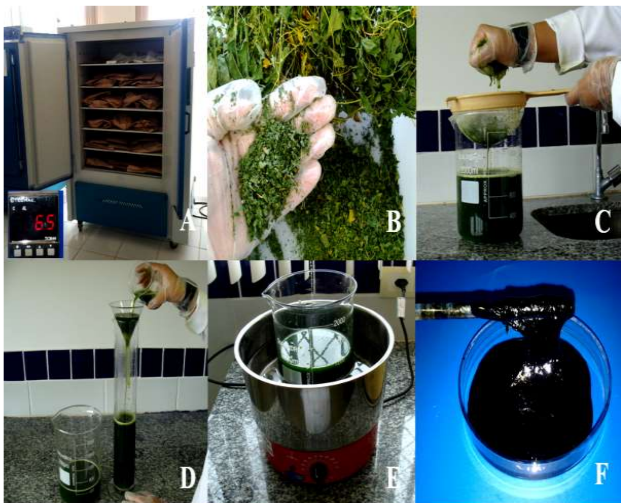
Figura 2 - Processamento da amostra vegetal e obtenção do extrato de Momordica charantia : A. Secagem em estufa de circulação forçada; B. Trituração manual do material foliar seco; C. Retirada dos resíduos sólidos; D. Filtração em algodão; E. Evaporação em banho maria a 40°C; F. Extrato bruto concentrado.
