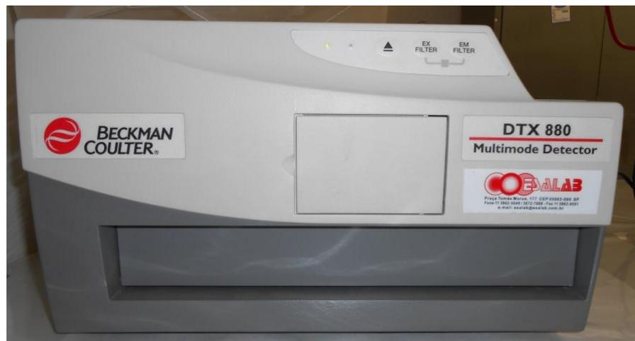
**Figura 7.** Espectrofotômetro utilizado para a leitura da quantificação proteica.
