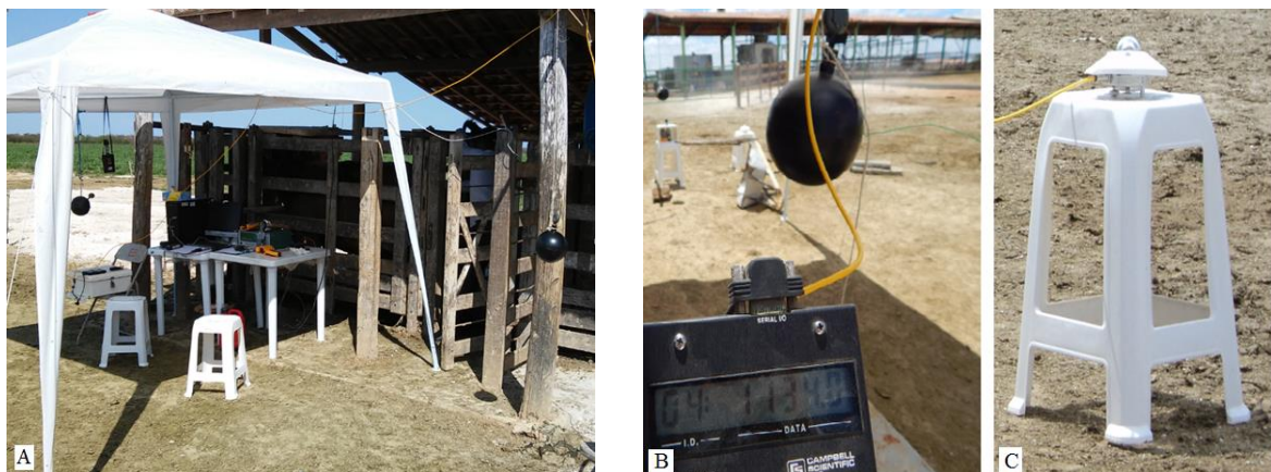
Figura 3: (A) Tronco de contenção e área de coleta de dados. (B) display, demonstrando a irradiância de ondas curtas ( \text{Wm}^{-2} ). (C) Radiômetro.
