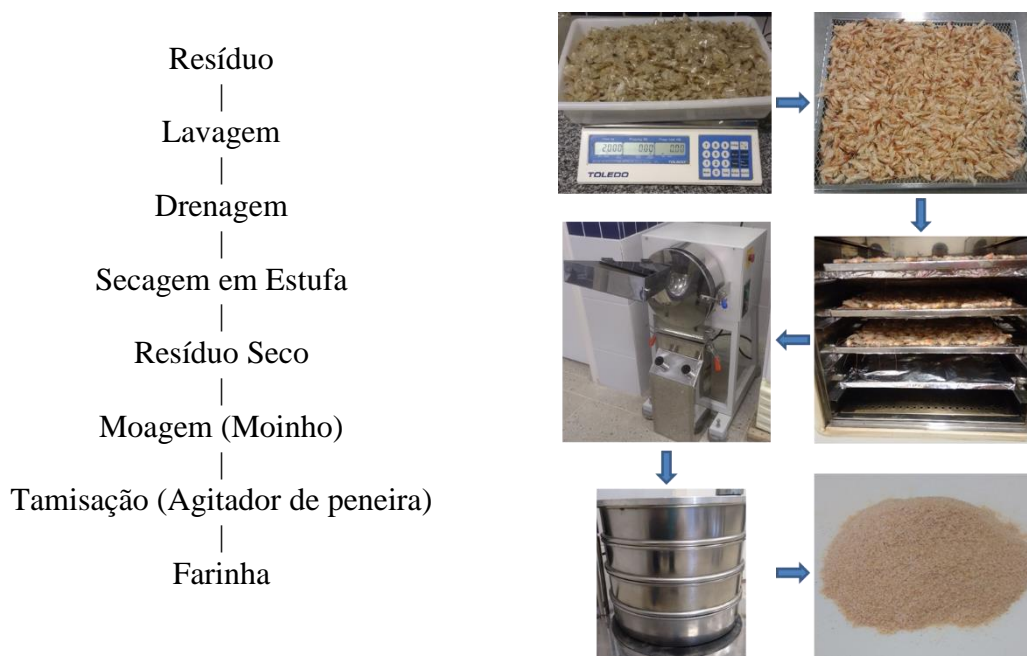
Figura 3. Fluxograma operacional para a obtenção da farinha do resíduo (exoesqueleto) do processamento do camarão.
