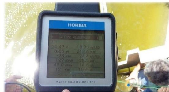
Figura 12: Verificação dos parâmetros com medidor de multiparâmetros
