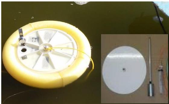
Figura 19: Câmaras de coleta de gases difusivos
