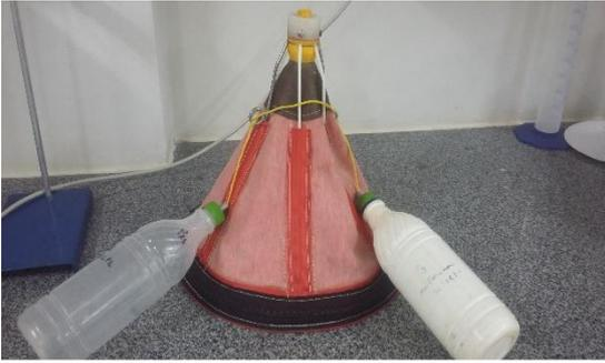
Figura 15: Funis de coleta ebulitiva de gases
