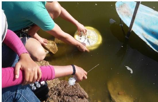
Figura 20: Coleta de gases com as câmaras difusivas
